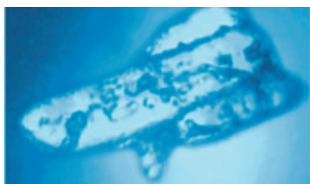
MSM cristalizado ampliado mostra oclusões que podem conter água e impurezas.
